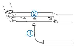
Es gibt nur eine Möglichkeit den Stecker mit dem Anschluss zu verbinden. Wenden Sie beim Verbinden des Steckers mit dem Anschluss keine Gewalt an, da dies zu Schäden führen könnte
