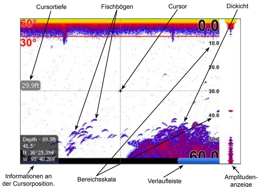
**Wenn der Cursor auf dem Bildschirm sichtbar ist, verwenden Sie die Verlaufeiste, um einen Bildlauf der Sonarseite zurück durchzuführen und frühere Sonarergebnisse anzuzeigen. Wenn der Cursor sich auf dem Bildschirm befindet, zeigt das Sonar keine Sonarergebnisse in Echtzeit.**
