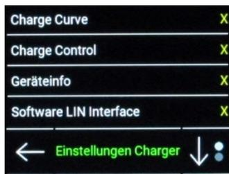
Ist kein philippi Ladegerät der Serie ACE angeschlossen bzw. das Ladegerät nicht mit Netzspannung versorgt, können keine Einstellungen vorgenommen werden.
