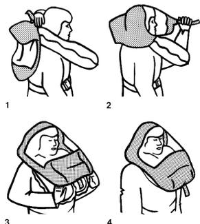
ACHTUNG: Die Sprayhaube darf nicht mit dem Schwimmkörper verdreht sein!
