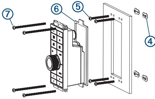
**16** Befestigen Sie die Anietmutter an der Montagefläche, indem Sie die kürzeren Schrauben **5** in das kleinere innere Loch einschrauben.
