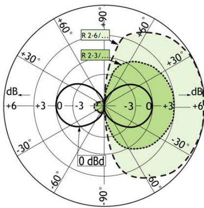
Horizontales Strahlungsdiagramm (horizontale Abdeckung) bei vertikal polarisierter Antennenmontage.
